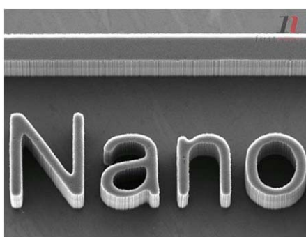
Вертикально выстроенный массив углеродных нанотрубок
