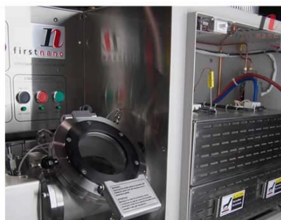
Загрузчик для загрузки образцов в предварительно нагретую камеру и печь типа FastCool™
