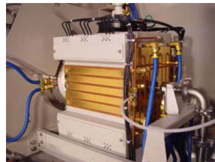
Ифракрасный нагрев (IR) для быстрой термообработки (RTP) > 1150 °C
