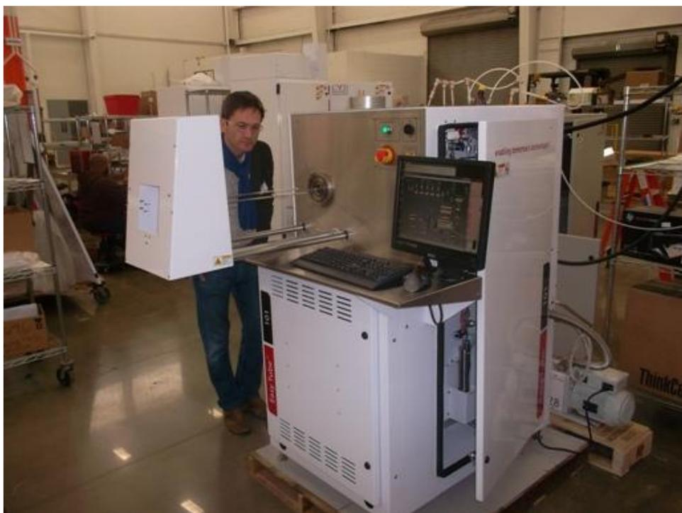
Это полностью автоматизированная установка: надо положить образец на подложкодержатель и нажать кнопку загрузки. У Мурфилда, к примеру, нужно рукой продвинуть фланец на котором консольно закреплен подложкодержатель для закрывания камеры. На фото ниже красной стрелкой показан подложкодержатель Firstnano – это трубка с площадкой под образец, выполненная из высокочистого кварца с такими размерами, что можно положить либо 2 образца 25 x 25 мм или один 25 x 50 мм
