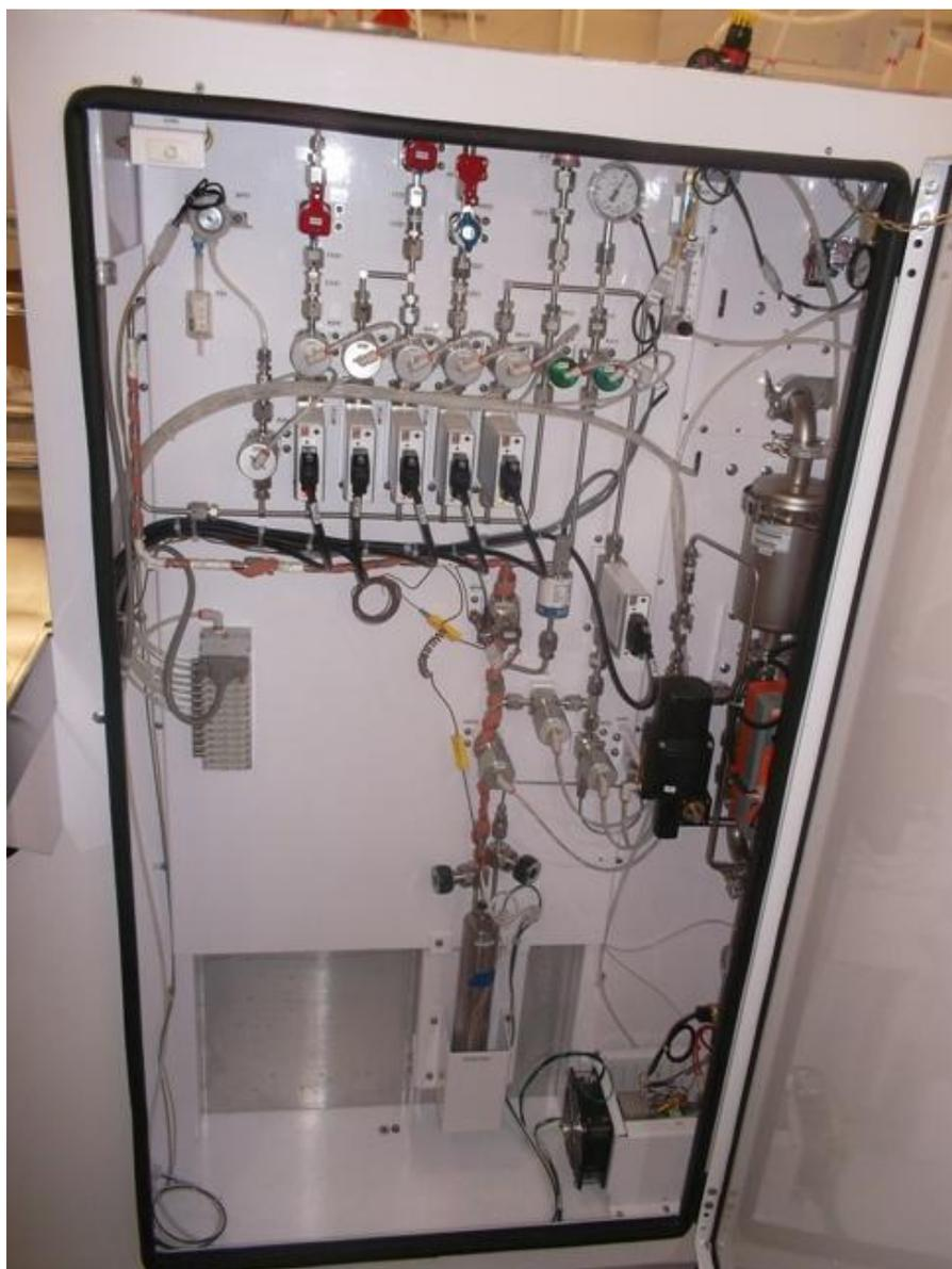
На фото выше показан газовый шкаф установки ET-101 – видно 4 входных газовых линии и одна линия подачи жидкого прекурсора – внизу стоит испаритель-барботер (он нужен для подачи паров воды в реактор – это нужно для роста сверхдлинного массива углеродных нанотрубок). Металлический цилиндр в средней части фото и справа- это молекулярное сито (предотвращает попадание углеродных остатков, хлопьев в вакуумный насос)
