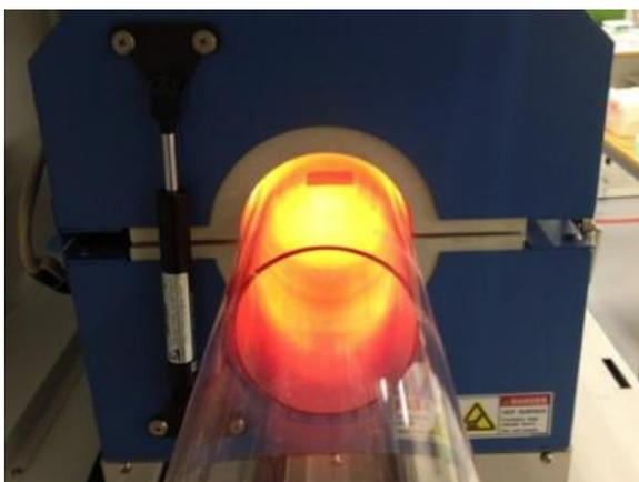
После стадии роста графена идет стадия быстрого остывания медной фольги (образца). У разных производителей эта стадия организована по-разному: некоторые отодвигают резистивную печь (PlanarTech), другие (FN, Moorfield) включают сильный обдув реактора
